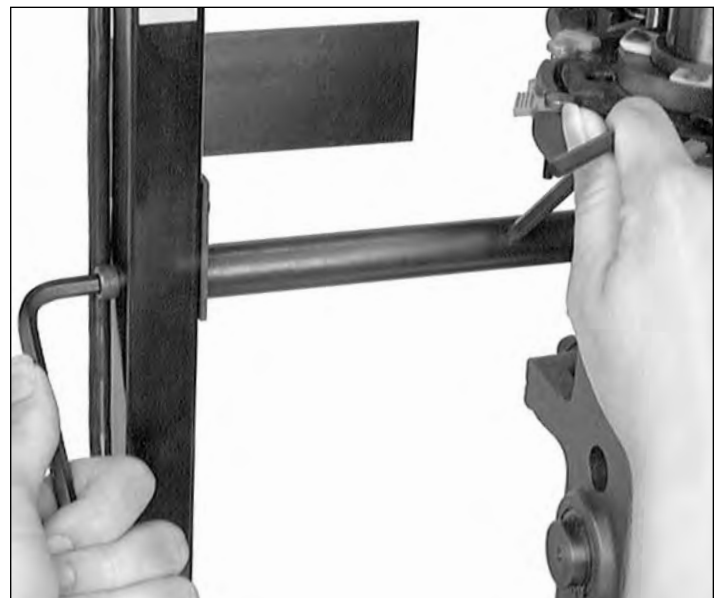
Fig. 3: Debe tensarlos bien con ayuda de una llave hexagonal (Allen wrench).
