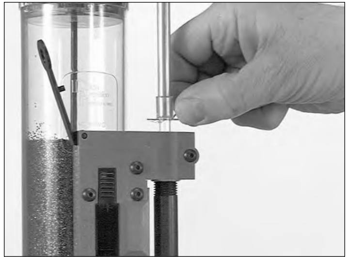
Fig. 14 Levante el sensor (switch lever) del sistema de aviso anticipado (early warning system). Invierta el tubo recolector y colóquelo encima del tapón del tubo protector de seguridad (magazine shield cap) (no 13957)
