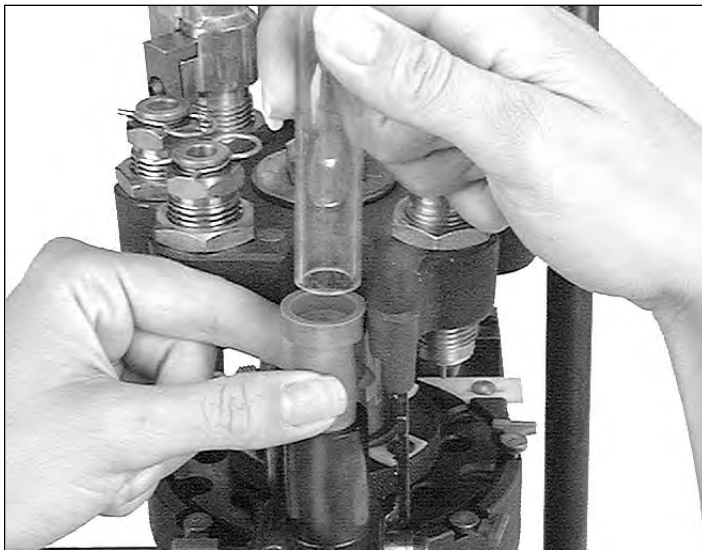
Fig. 4. Esta fotografía le indica la posición adecuada del tubo alimentador de vainas y del adaptador.
