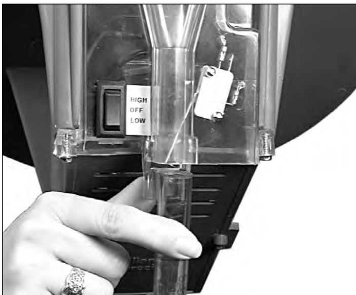
Fig. 5. Fíjese en la flecha. Hay un pequeño espacio que permite que el dado quede ajustado sin que tenga que extraer el dosificador de pólvora.
