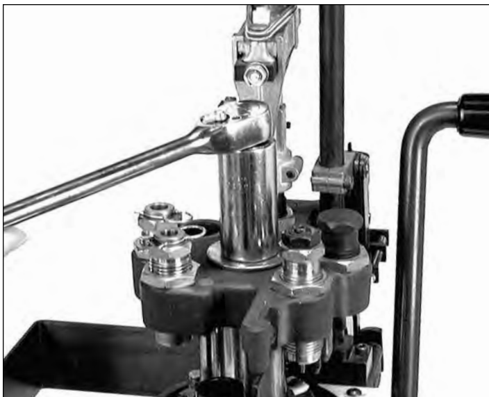
Fig. 21: Utilice una llave inglesa de 15/16 pulgadas para desajustar el tornillo.
