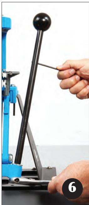
Porre la chiave esagonale da 5/32" (3,9mm) o un cacciavite attraverso il foro nell'impugnatura per bloccarla mentre si stringe il dado di serraggio usando una chiave da 7/8" (o una regolabile).
