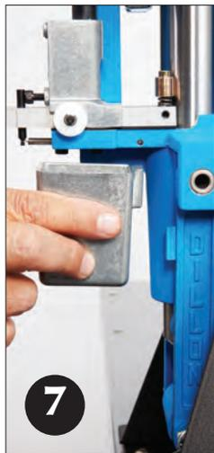
Inserire il contenitore per gli inneschi spenti sul perno di montaggio a forma di cuneo sul braccio di collegamento destro.
