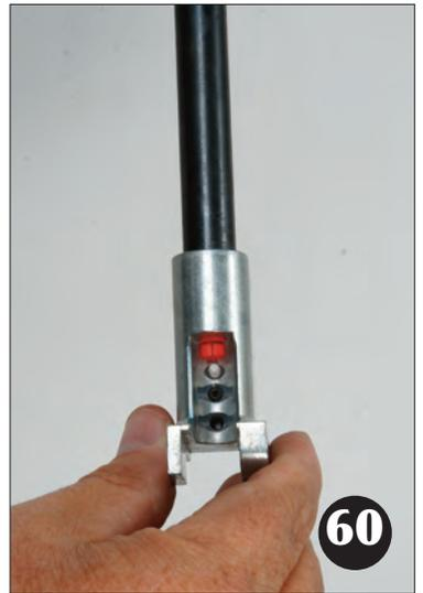
Prima di reinstallare la colonna inneschi, si deve cambiare il tubo porta inneschi al suo interno. Sostituirlo con il tubo per l'alloggiamento di inneschi large, ruotarlo leggermente sino a quando il tubo non scende di mezzo centimetro sino alla posizione corretta. È possibile vedere la sua posizione corretta nella foto 60. Riposizionare tappo zigrinato serrandolo con le dita. Non è necessario serrare eccessivamente.
