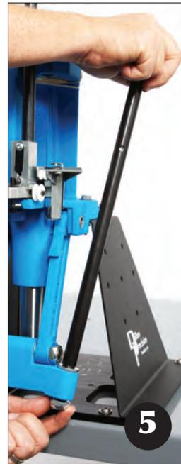
Rimuovere la rondella e il dado di bloccaggio dall' impugnatura. Inserire la rondella nella leva ed in seguito introdurre la leva nel foro. Bloccare il dado manualmente nella parte sottostante.
