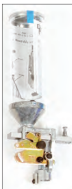
1 e. Medidor de pólvora con barra de pólvora pequeña instalada
