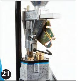
Inserire perno e brugola per fissare il dosatore senza serrarla in maniere eccessiva.
