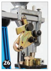
La parte superiore della bacchetta di chiusura del dosatore è piegata a 90°. Rimuovere la clip metallica inserita nel foro nella parte superiore della bacchetta, inserire bacchetta sia nella guida sia nel foro del meccanismo di chiusura del dosatore ed inerire la clip di fissaggio.
