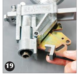
Utilizzando l'appropriata chiave a brugola , rimuovere la vite dalla base del dosatore come mostrato in foto 18 e 19.
