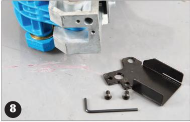
Prendere il contenitore inneschi spenti e la sua staffa di montaggio, recuperare appropriata brugola e le due viti da 3/32 x 3/8" dal sacchetto delle chiavi a brugola.
