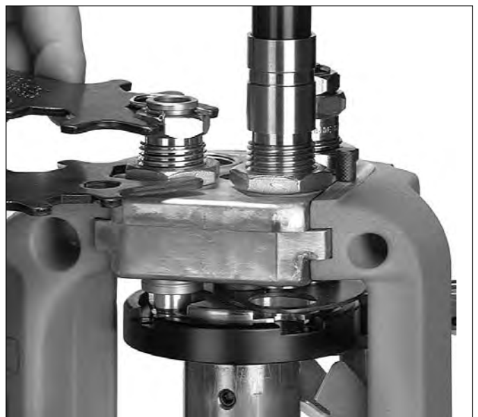
Abb.28 [Figure 28] - Einsetzen der Geschoß-Setzmatrize [bullet seating die] auf Station-3.
