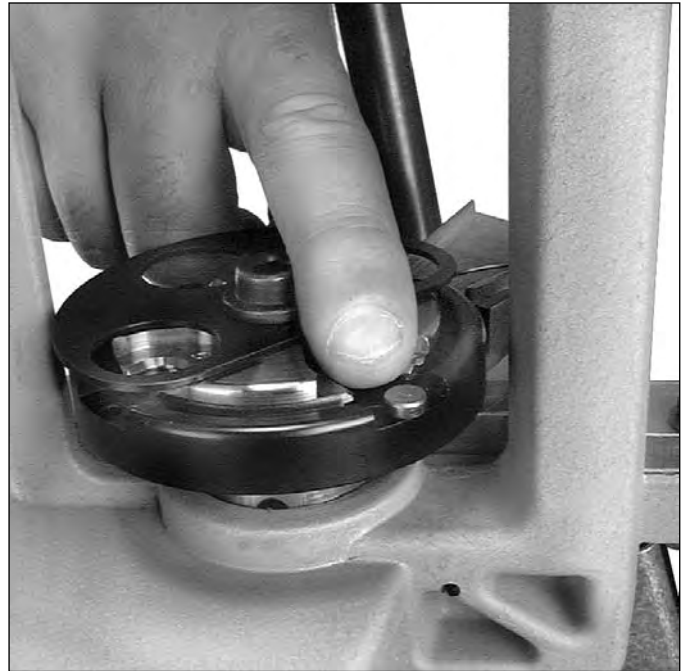
Abb.21 [Figure 21] - Einsetzen eines Messing-Fixierstiftes [brass locator button] auf Station-2.
