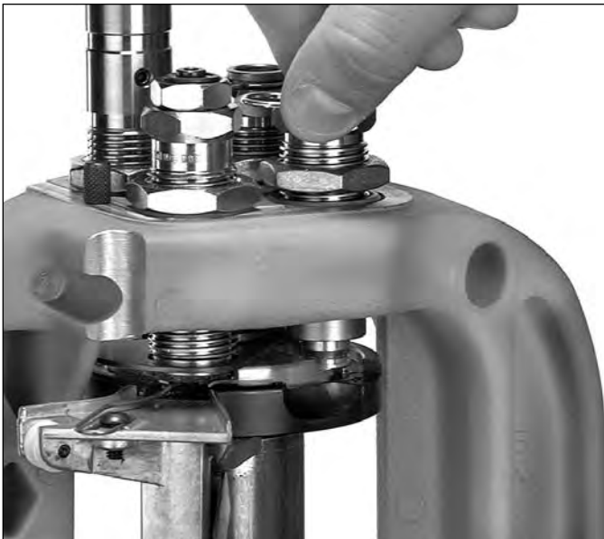
Abb.30 [Figure 30] - Einbau der Taper-Crimp-Matrize [taper crimp die] auf Station-4.
