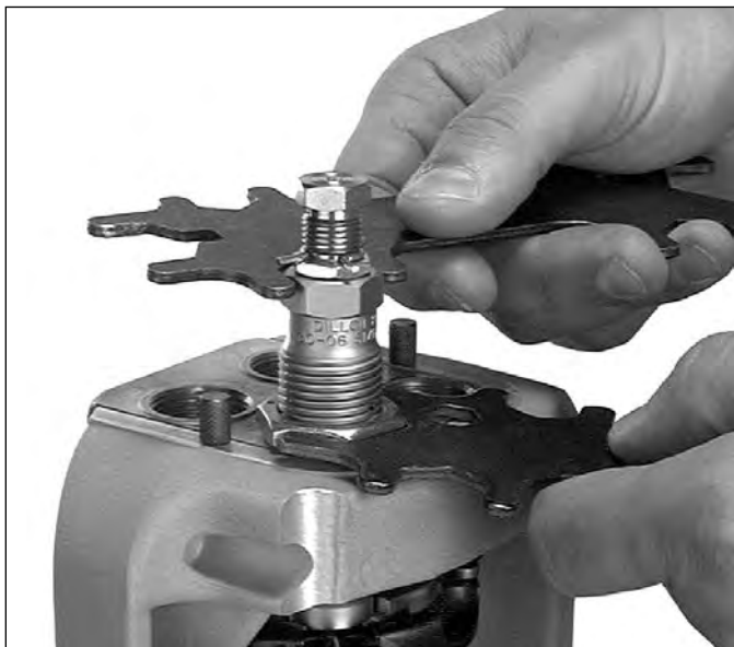
Abb.12 [Figure 12] Installierung der Kalibrier/Entkapselungs-Matrize [sizing/decapping die] auf Station-1.
