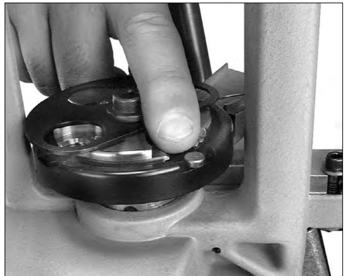
Abb.32 [Figure 32] Setzen eines Messing-Fizierstiftes auf Station-2.
