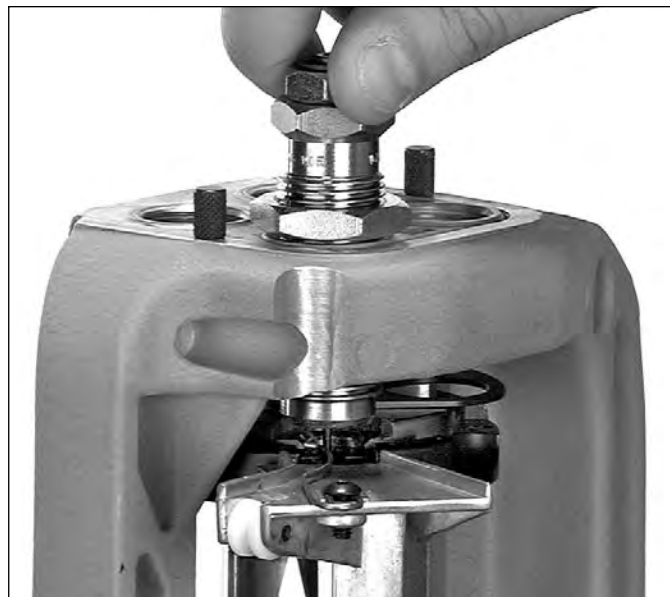
Abb.23 [Figure 23] - Einbau einer Kalibrier-/Entkapselungsmatrize [sizing/decapping die] auf Station-1.
