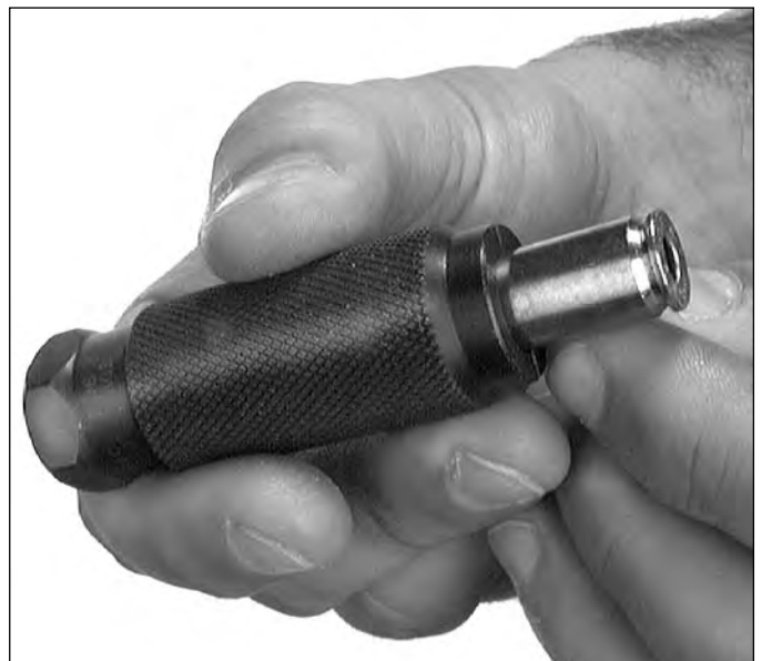
Abb.14 [Figure 14] - Die Hülse wird in das Hülsenmaß [case gage] hineingeschoben.
