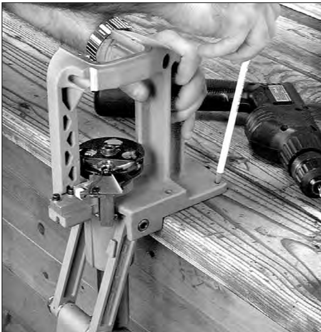
Abb.3 [Figure 3] - Die Werkbank wird markiert und die Ladepresse dabei als Schablone benutzt.
