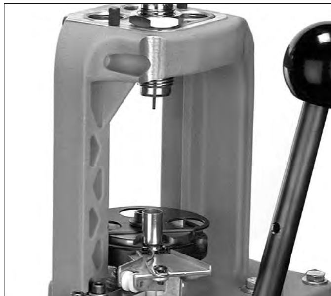
Abb.24 [Figure 24] Einsetzen einer leeren Patronenhülse auf Station-1.
