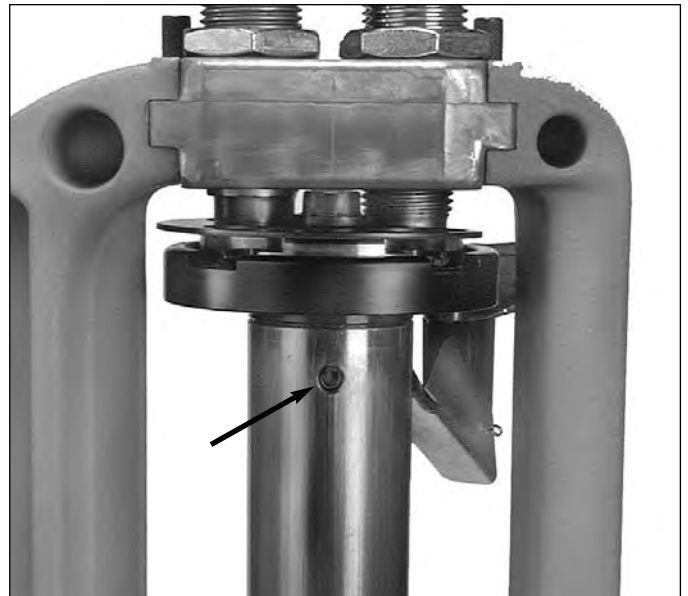
Abb.5 [Figure 5] Position der Drehteller-Setzschraube [shellplate bolt setscrew]
