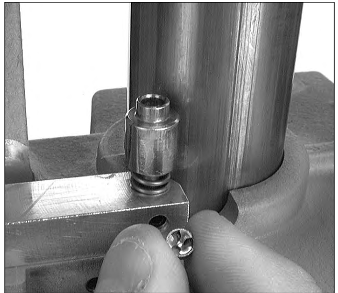
Abb.34 [Figure 34] - Einführung eines Zündhütchens in den Zündhütchenbehälter auf Station-1.
