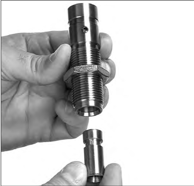
Ab.15 [Figure15] - Büchsen-Pulver-Trichter [rifle power funnel] wird in die Pulvermatrize [powder die] hineingeschoben.
