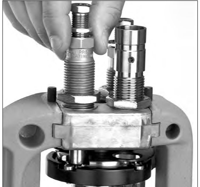
Abb.17 [Figure 17] - Einbau der Geschöß-Setzmatrize [bullet seating die] in Station-3.
