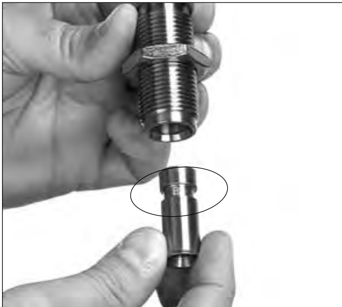
Abb.16 [Figure 16] - zeigt die Rille im Büchsen-Pulvertrichter [rifle powder funnel].
