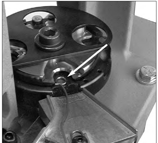
Abb.9 [Figure 9] Der Zündhütchen-Behälter ist unter der Bühne sichtbar.
