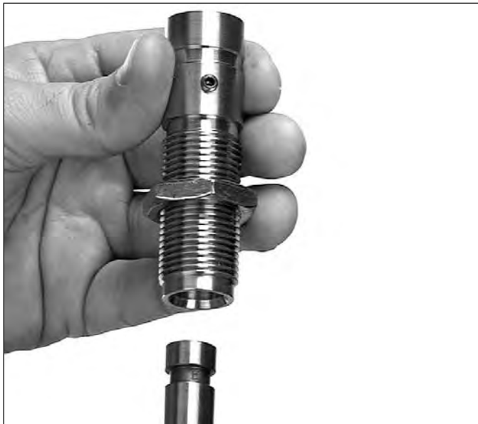
Abb.25 [Figure 25] - Pistolen-Pulvertrichter [pistol powder funnel] wird in die Pulvermatrize [powder die] eingesetzt.
