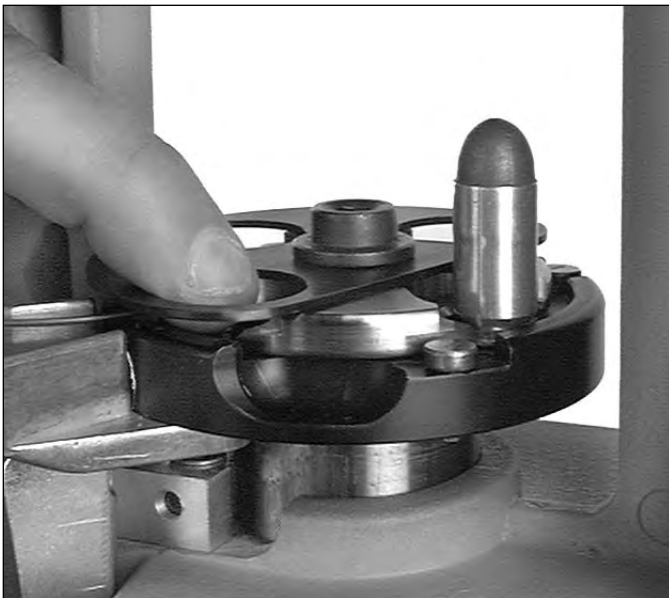
Abb.37 [Figure 37] - Der Drehteller [shellplate] wird auf die 4. Station transportiert.
