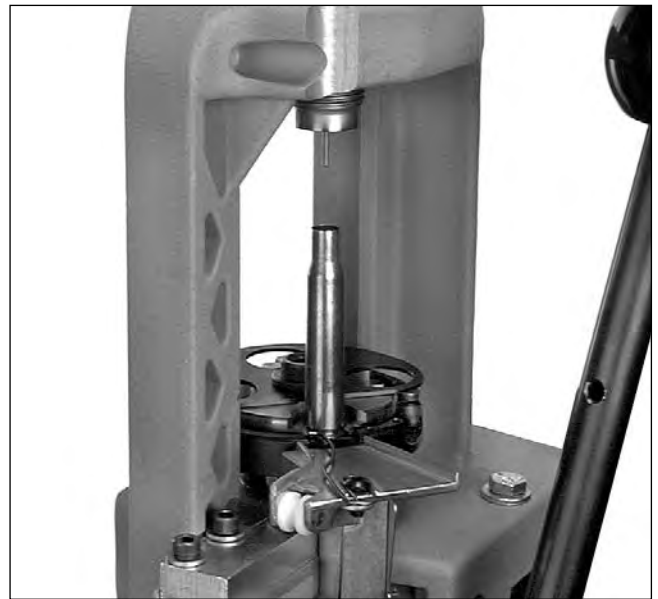
Abb.13 [Figure 13] - Einsetzen der Patronenhülse auf den Drehteller [shellplate].
