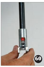
Avant de réinstaller le logement d'amorce, vous devez passer du tube interne «small» au «large». Dévissez l'écrou moleté et retirez le tube interne "Small". Remplacez-le par le tube «large» et tournez-le légèrement jusqu'à ce que vous sentiez l'ergot se trouvant sur le tube interne se mettre en position. Sa position adéquate est indiquée sur la photo 60. Replacez l'écrou moleté et serrez-le uniquement avec les doigts. Il est inutile de serrer excessivement.
