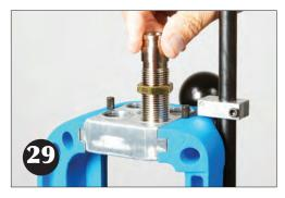
Repérez la station deux sur la plateau porte outils de la RL 550B et insérez l'ensemble de doseuse et l'entonnoir à poudre, en le vissant jusqu'à environ à mi-chemin. Vous effectuerez les réglages finaux quand vous ajusterez votre charge de poudre juste avant de recharger. Pour l'instant, l'ensemble e doit ressembler à la photo 30 à droite.
