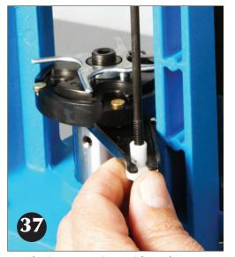
Quand la doseuse et la tige de sécurité intégrée sont correctement positionnées, la tige doit pendre à proximité immédiate du support de retour dans lequel elle sera installée. Placez la douille blanche dans l'encoche sur le sup port de retour et enfoncez-la comme indique sur les photos 36 et 37.
