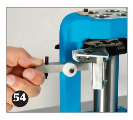
Prenez la barre d'amorçage «large» qui est dans le sac d'accessoires et positionnez-la en plaçant la tête de l'amorceur dans le trou sous la station un de la plateforme.
