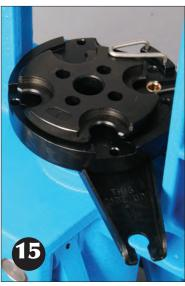
Placez le ressort de bille d'indexage dans le trou à gauche du centre sur la plateforme. Placez la bille d'indexage dans le même trou. Ensuite, placez la plateau support de douilles (shellplate) (de la boîte de conversion de calibre du RL 550B) **côté numéroté en haut sur** la plateforme afin de l'aligner avec le trou central.
