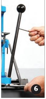
Placez une clé hexagonale de 5/32" ou un tournevis à travers le trou dans la poignée pour la tenir tout en serrant l'écrou de blocage en utilisant une clé de 7/8" (ou une clé réglable).
