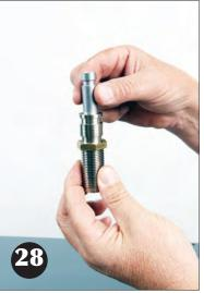
Utilisez une clé hexagonale de 5/32" pour desserrer les deux vis de collier de serrage sur le doseuse et enlevez le support de doseuse. Placez l'entonnoir à poudre "powder funnel" (se trouvant dans la conversion de calibre RL 550B) dans le support de doseuse avec l'extrémité rainurée vers le haut du support de doseuse comme indiqué. L'entonnoir à poudre doit monter et descendre librement.
