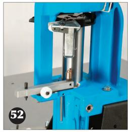
Placez le levier en position basse et notez la position de la glissière d'amorçage. Ensuite, démontez la glissière et mettez-la de côte.
