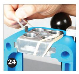
Vous pouvez maintenant enlever l'élastique à garder les goupilles du plateau portes outils en place lors du transport afin de préparer l'installation du système de doseuse automatique.
