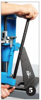
Enlevez la rondelle et l'écrou de blocage qui est sur l'ensemble de poignée. Tenez la rondelle audessus du trou du côté droit de la manivelle et insérez la poignée. Commencez à serrer l'écrou de blocage sur la poignée à la main.
