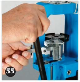
Abaissez lentement la plateforme et laissez la glissière d'amorçage reposer dans sa position adéquate comme indique sur la photo 56.
