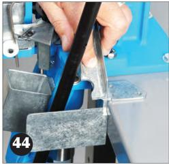
Utilisez deux vis ou boulons pour fixer le support à votre banc. Le caisson de récupération de cartouches glisse simplement sur le support et sera dans la bonne position pour récupérer les cycles chargés.
