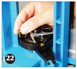
Vous pouvez maintenant placer les trois plots de positionnement en laiton (de la boîte de conversion de calibre du RL 550B) dans les trous restants sur la plateforme. Leurs positions appropriées sont indiquées à droite sur la photo 23.
