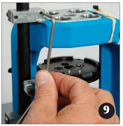
Placez l'extrémité angulaire de la tige de commande du système d'amorçage dans le trou sur le support de tige de commande (flèche du haut, photo 11), puis...
