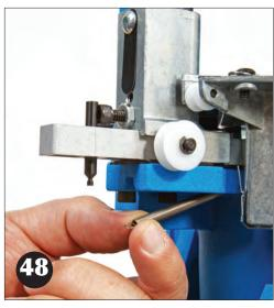
Décrochez le ressort de retour de barre d'amorçage qui est sur la glissière et laissez-le pendre.
