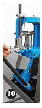
Tirez levier de commande bien vers le bas et tirez vers l'arrière la glissière d'amorces. Alignez la tige de commande afin qu'elle passe entre le petit rouleau blanc sur le support de rouleau (flèche du milieu, photo 11) et le rouleau blanc plus grand sur la glissière d'amorçage (flèche du bas, photo 11).
