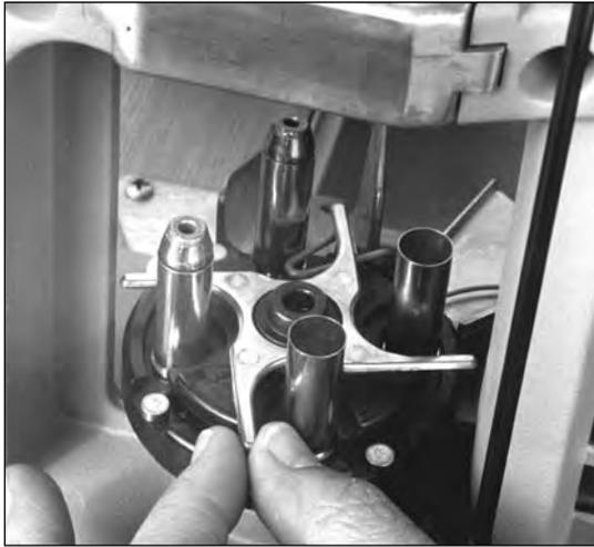
**FIG 9.** En esta fotografía le mostramos la forma correcta de girar el amarravainas (shellplate) y el lugar donde quedan colocados los pins localizadores (locator buttons).
