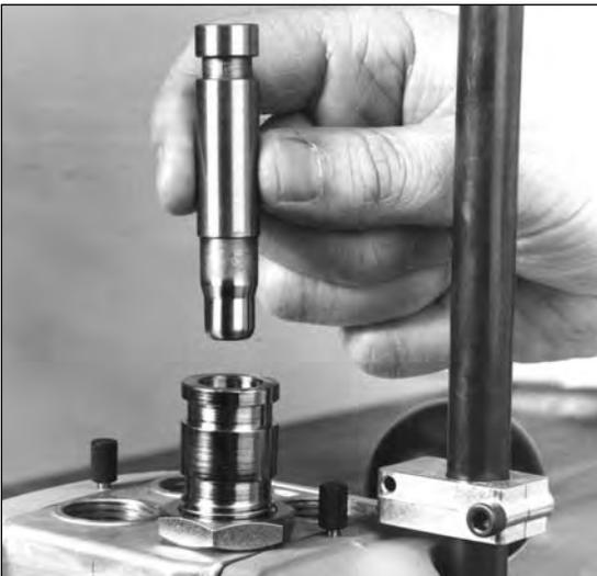
**Fig 18.** Introduzca el embudo de pólvora (powder funnel) dentro del dado de pólvora (powder die) tal y como se le muestra en la fotografía. Este debería moverse libremente dentro del dado.
