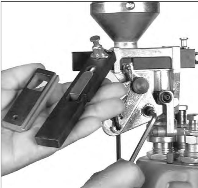
Fig 23. Desajuste el tornillo de la palanca del dosificador (bellcrank screw) (no 13904) lo suficiente para que le permita extraer la barra de pólvora (powder bar). Coloque la nueva barra de pólvora y ajuste de nuevo el tornillo.
