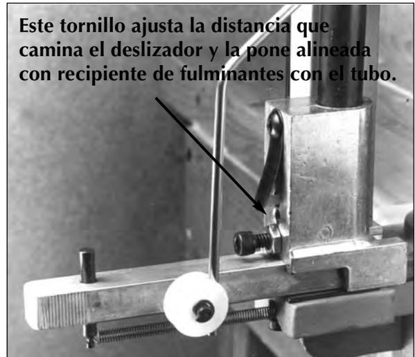
**FIG 12.** La varilla operadora (operating rod) ha provocado que el deslizador de fulminantes (primer slide) quede dentro del cuerpo del alimentador de fulminantes (primer feed body) donde automáticamente recogerá un fulminante.
