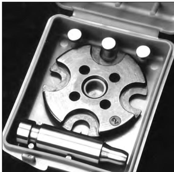
**FIG 4.** Esta fotografía enseña el conversion con embudo; amarravainas, pins localizadores.
