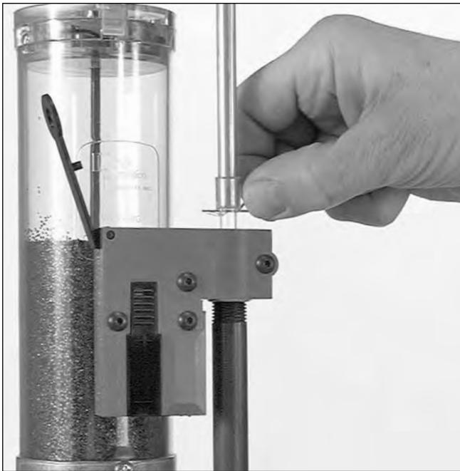
**Fig 25. Coloque los fulminantes en el tubo alimentador (primer magazine)**
