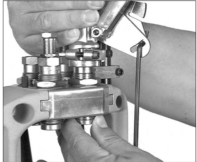
**Fig 19.** Puede ajustar fácilmente el dado de pólvora (powder die) simplemente girándolo en el portadados (toolhead) mientras sujeta el dosificador de pólvora (powder measure).
