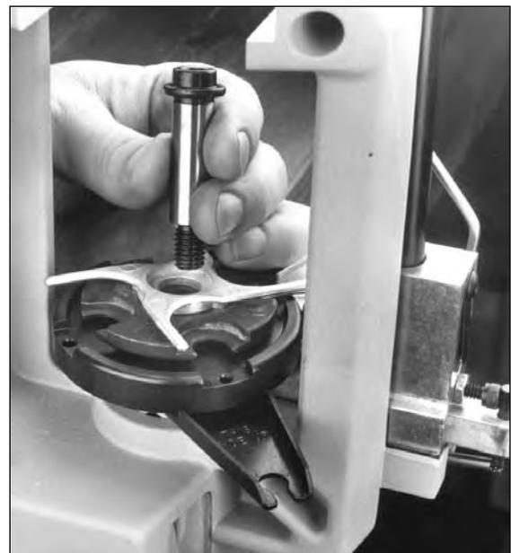
**FIG 8.** Deberá insertar el tornillo del amarravainas (shellplate bolt) a través de la estrella indicadora (index sprocket) y después a través del amarravainas (shellplate).
