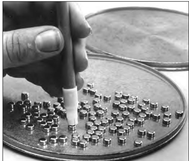
Figura 24. En esta fotografía le mostramos la recolección de fulminantes en el platillo (que puede adquirir en Dillon)
