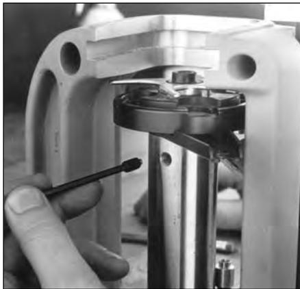
**FIG 10.** Aquí le mostramos dónde ha de colocar el tornillo de seguridad (brass tipped set screw). Recuerde que debe ajustarlo.
