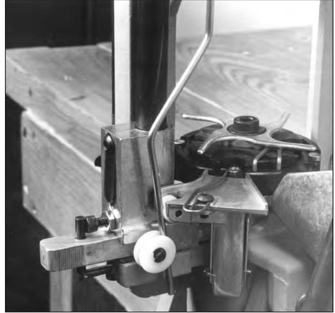
**FIG 11.** Esta es la forma correcta de alinear la barra operadora (operating rod). El deslizador de fulminantes (primer slide) debe quedar colocada correctamente cuando la plataforma está en su posición inferior (baja).
