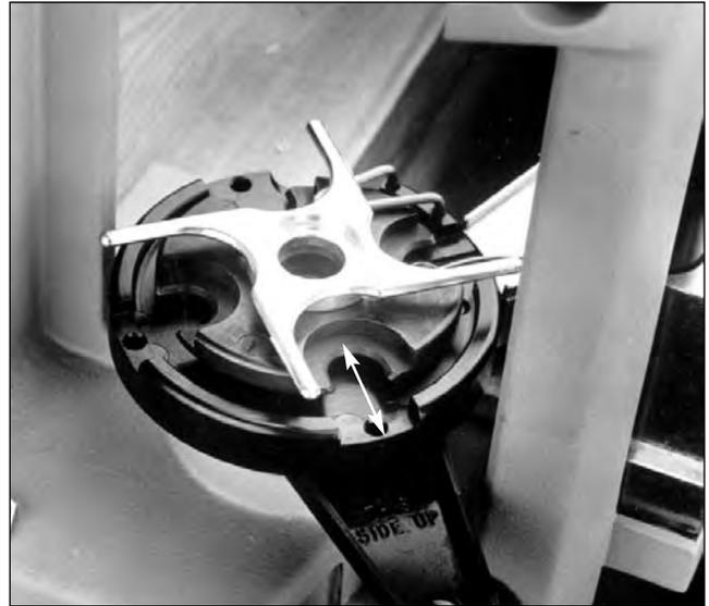
**FIG 7.** En esta fotografía puede observar la posición correcta de la estrella indicadora (index sprocket). Las cavidades donde quedan colocados los pins localizadores también han sido alienadas en el amarravainas.
