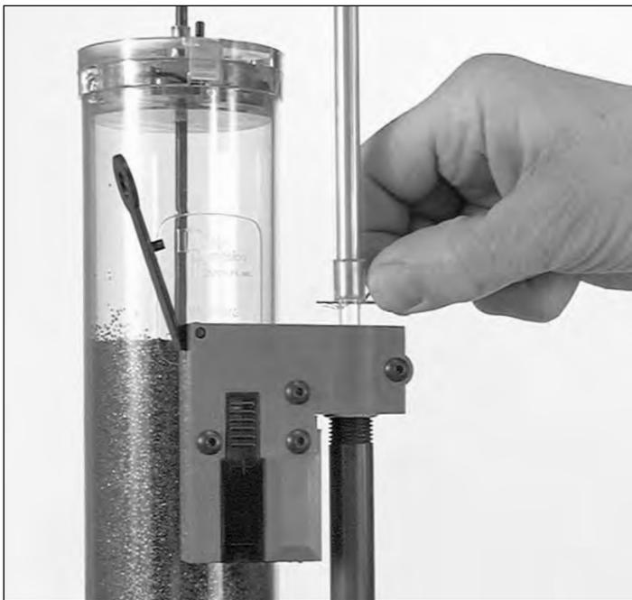
**Abb. 14:** Wenn Sie die Zündhütchen in das Magazinrohr füllen, stellen Sie bitte sicher, dass das Röhrchen mittig auf der Magazinrohr sitzt, bevor Sie den Splint herausziehen.
