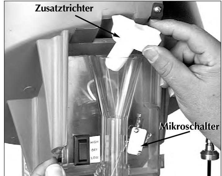
**Abb. 15:** Der Mikroschalter schaltet die Hülsenzuführung ab, wenn die Zuführrohre voll ist. Der Zusatztrichter dient der sicheren Zuführung von kurzen Hülsen wie 9 mm kurz oder 9 mm Luger.
