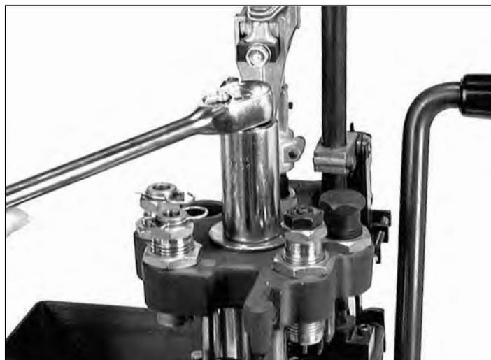
**Abb. 21:** Mit einem 15/16 Zoll Schlüssel können Sie die Kopfhalteschraube lösen.
