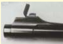
Die offene Visierung besteht aus einem Zwei-Klappen-Expressvisier und einem feinen Silberperlkorn. Ein klappbares Dämmerungskorn nach Art Holland & Holland dient als kontrastreiches Visier für kurze Entfernungen.
