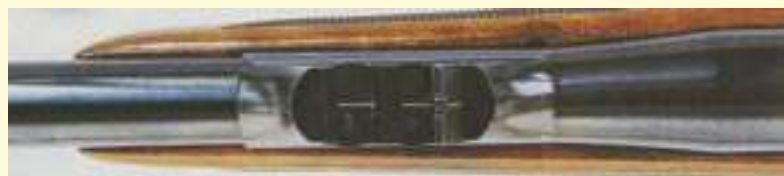
Die offene Visierung besteht aus einem Zwei-Klappen-Expressvisier und einem feinen Silberperlkorn. Ein klappbares Dämmerungskorn nach Art Holland & Holland dient als kontrastreiches Visier für kurze Entfernungen.
